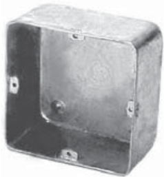
สแควบ็อกซ์จัมโบ้ออบสังกะสี Hot Dip Galvanized Jumbo Square Boxes 4-11/16 X 4-11/6 X 2 (119 X 119 X 50 mm) หน้า 1.2 mm.
